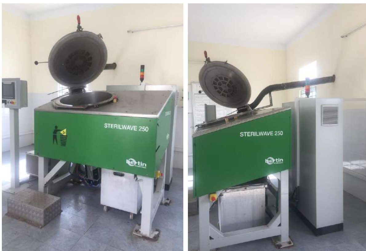
Hình PLI.10. Hệ thống thiết bị xử lý CTR y tế lây nhiễm bằng công nghệ vi sóng tích hợp nghiền cắt trong cùng khoang xử lý – Model: SterilWave 250
